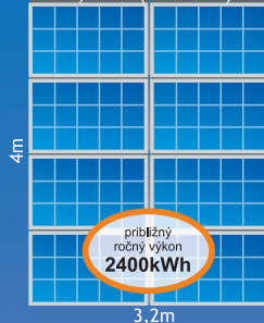
MAXIMÁLNA HODNOTA OHREUV VODY V MESAČI JÚN (22.06.2011) + 53°C ENERGETICKÝ ZDROJ: FV PANELY 1,0kW, LX ACDC/M+K 100L
